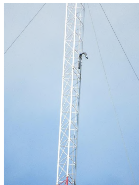
Photo 4 : En haut : Mât de mesures, en bas à gauche : zoom sur le microphone haut situé à 50m environ, en bas à droite : zoom sur l'enregistreur dans son boîtier de sécurité.
