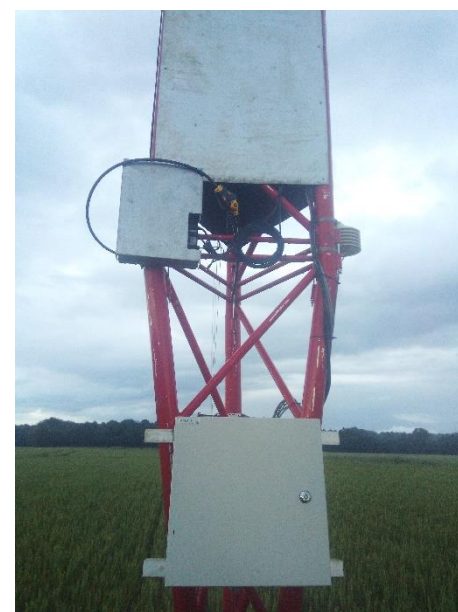
Photo 4 : En haut : Mât de mesures, en bas à gauche : zoom sur le microphone haut situé à 50m environ, en bas à droite : zoom sur l'enregistreur dans son boîtier de sécurité.
